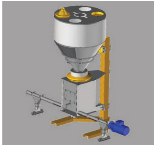
Trémie peseuse avec départ pour alimentation de 2 circuits
